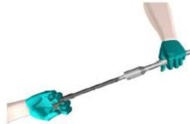
À l'aide de la molette, sortir le tube intérieur du tube extérieur
